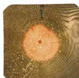
Rode Noordse Den (Grenen) Pin rouge du Nord diepe impregnatie imprégnation en profondeur
