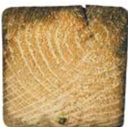
Witte den Épicéa oppervlakkige impregnatie imprégnation superficielle
