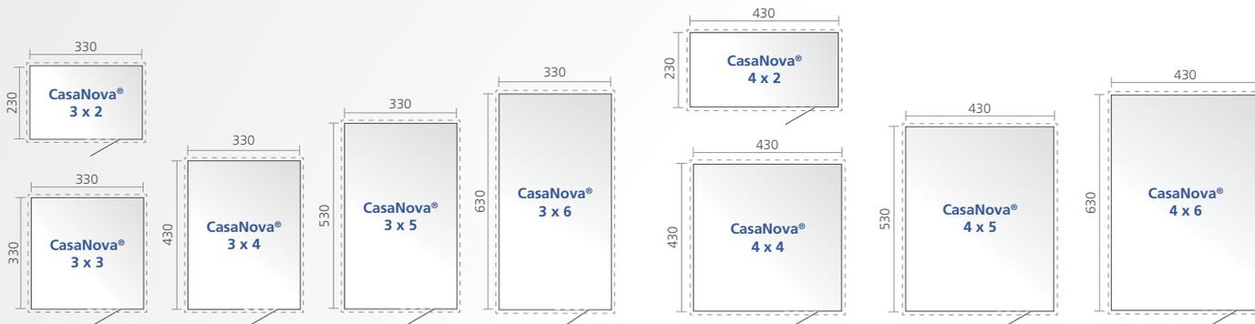
Les dimensions indiquées sont celles du socle, ligne pointillée = avancée du toit
